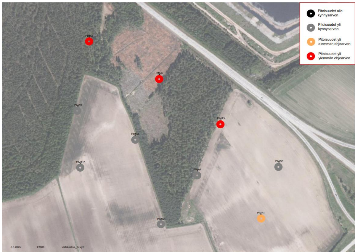
Kuva 3-27. Maaperän haitta-ainekartoituksen tutkimustulokset pitoisuustasoinnalla kartalla.
