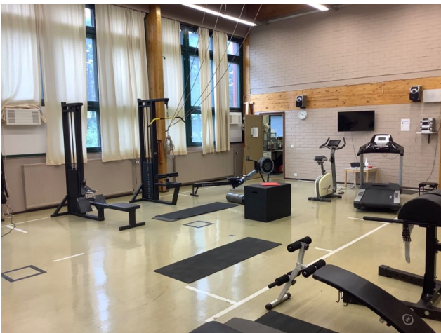
Tila 103. Liikuntasalin korvausilma tulee ulkoseinustalla olevien Mobair-laitteiden kautta, 3 kpl. Ikkunoiden korvausilma-aukot on tukittu.
