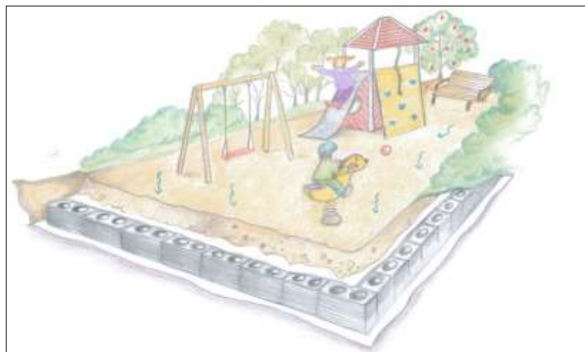
Kuva 11. Esimerkkikuva hulevesikaseteista. (Kuva: Ramboll)
